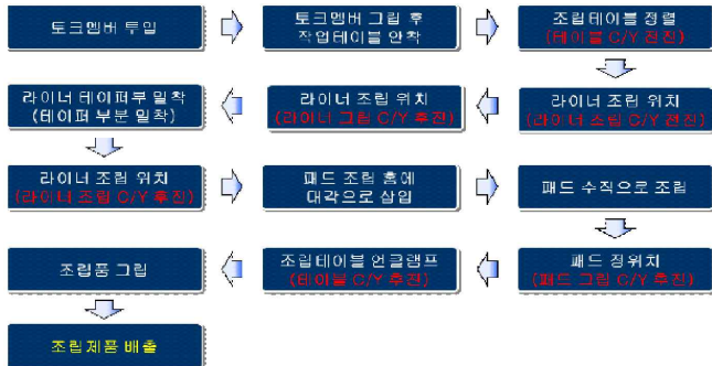
그림 6. 브레이크 모듈 조립 순서
