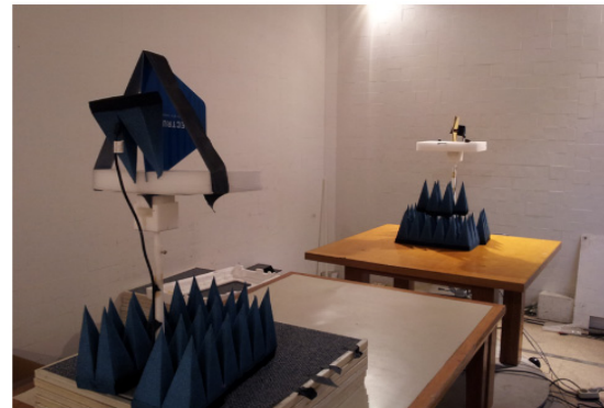
그림 4. 반사계수(혹은 정재파비) 구하는 과정 Fig. 4 Process to obtain reflection coefficient(or VSWR)
