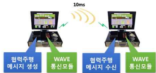
그림 1. WAVE 기술을 이용한 IVC 통신 시스템 Fig. 1 Inter vehicle communication system using WAVE technology
