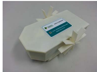
그림 8. 제안된 MSR의 제작 Fig. 8. Manufacturing of proposed MSR
