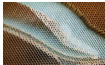
(d) Concave surface right(ball endmill, 1,300mm/min)
