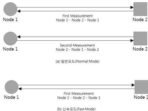
그림 1. SDS-TWR 거리측정 기법:일반모드 vs 신속모드
