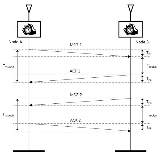
그림 2. SDS-TWR 일반모드에서의 시간 측정 동작
