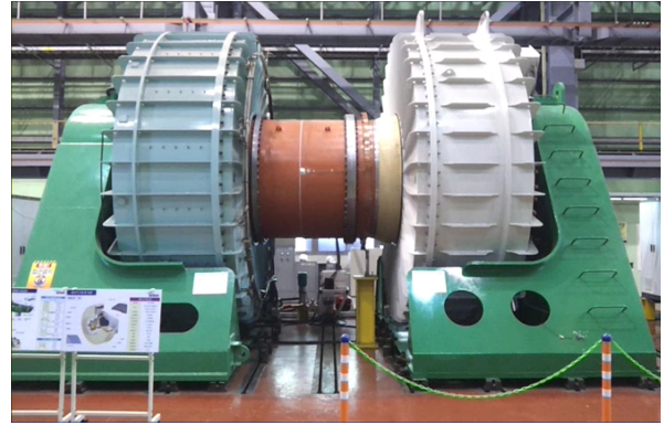
그림 3 발전기 형식시험 Fig. 3 Generator type test
