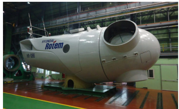
그림 5 HR-D86 풍력발전기 Fig. 5 Wind turbine generator (HR-D86)
