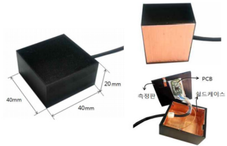
그림 3 구현된 정전용량 결합 전극의 외형 및 크기 Fig. 3 design and size of the capacitive-coupled electrode
