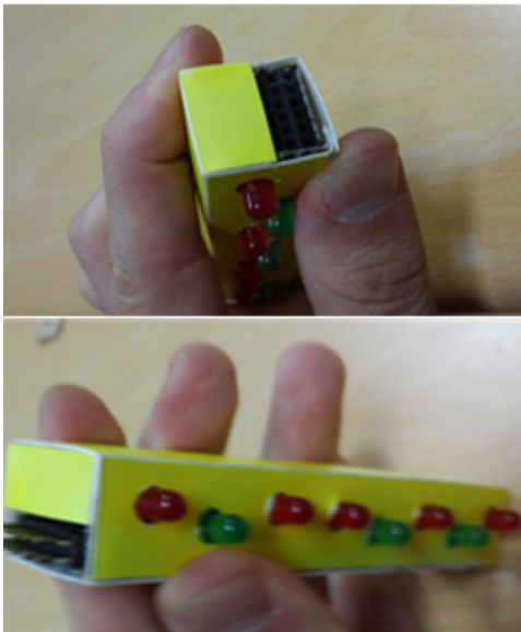
그림 4. 피아노 건반악기 보조 모듈의 블록식 구조 Fig. 4 Piano keyboard instrument auxiliary module structure of a block-type
