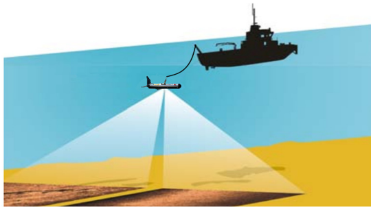
그림 5. 사이드스캔소나 운용방법 Fig. 5 How to Use Side Scan Sonar
