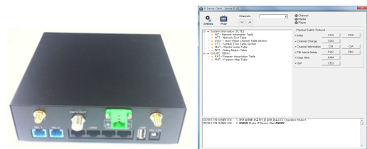
그림 9. 광 미디어 종단장치 시제품 및 에뮬레이터 Fig. 9. Optical Media Terminal Prototype and Emulator
