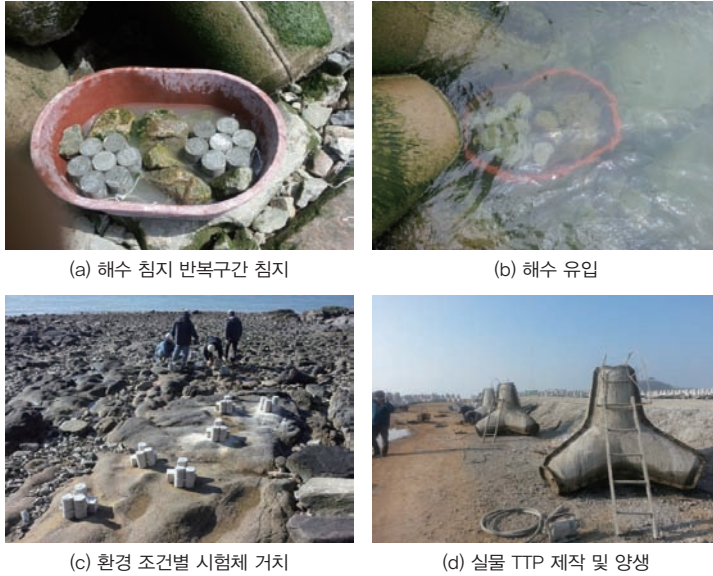
사진 3. 해양 환경용 혼합 콘크리트 공시체 및 소파공 블록의 준비
