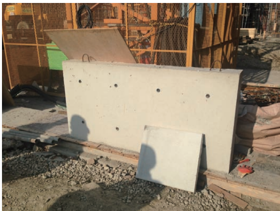
사진 3. RC 및 PC 노출콘크리트 색상 비교 평가
