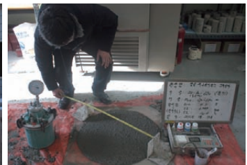
사진 6. 레미콘 실생산 성능 BP 테스트 일례
