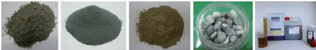
사진 5. 초고층 건축용 고성능 콘크리트 원재료 일례
