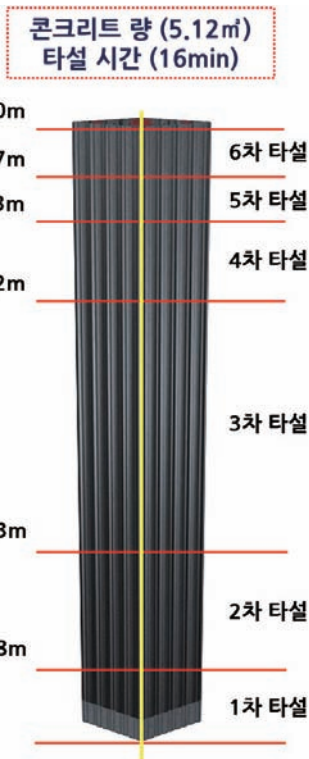
그림 3. Form-LPSRC 기둥 콘크리트 타설 단계
