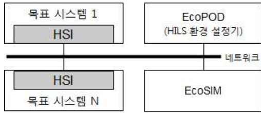
그림 1. EcoHILS 구조 Fig. 1 Architecture of EcoHILS
