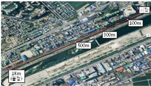
그림 14. 거리 관점의 RF 모듈 시험 Fig. 14 RF Module Test in View of Distance
