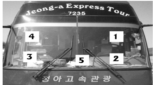
<그림 10> 단말기 부착 위치별 주행 시험 <Fig. 10> OBU position by driving test
