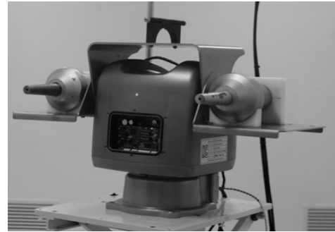
그림 4 스테레오 방사선 검출기 구성 Fig. 4 Stereo radiation detector configuration
