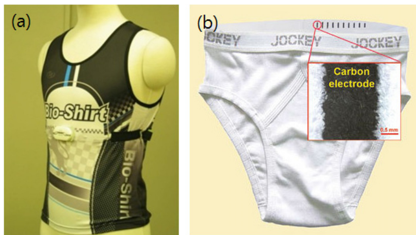
그림 2. 최근 스마트웨어 개발 예. (a) 바이오셔츠(한국전자통신연구원)와 (b) 바이오 센서 속옷 (Joseph Wang, University of California).
