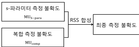
그림 3. 측정 불확도 주요 인자의 합성 Fig. 3. Combining measurement uncertainty by RSS method.
