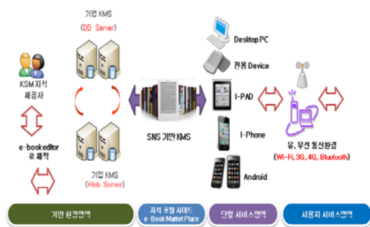
그림 1. e-book 형식의 KMS 서비스 구조 Fig. 1. Architecture of e-book type KMS Service
