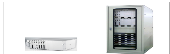
그림 4. 소용량 IMS 코어 제품화 모습 Fig. 4. The manufactured shape of small capacity IMS Core system
