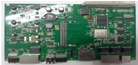
그림 6. 소용량 IMS 코어 하드웨어 모습 Fig. 6. The H/W shape of small capacity IMS Core system
