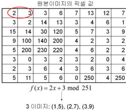
그림 1. (2,3)임계 시스템 계산과정 Fig. 1. computing procedure of (2,3) critical system
