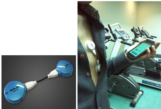
그림 6. 웨어러블 심전도 측정장치 Fig. 6 Wearable ECG measuring device
