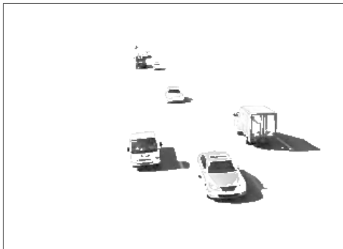
그림 5. 차량영상 투영 및 배경 변환 Fig. 5 Reflection of adjusted vehicle area and its shadow area and background transformation
