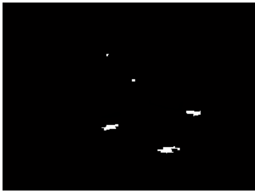
그림 7. 모폴러지가 적용된 sub-shadow 이미지 Fig. 7 Sub-shadow image after morphological operations
