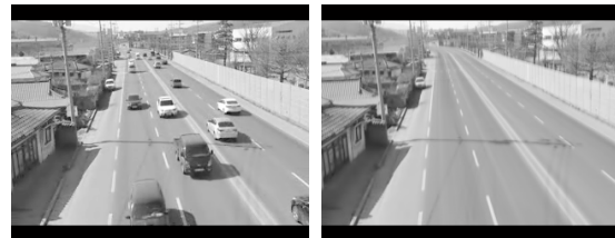
그림 3. 평균배경 예제 Fig. 3 Example of average background
