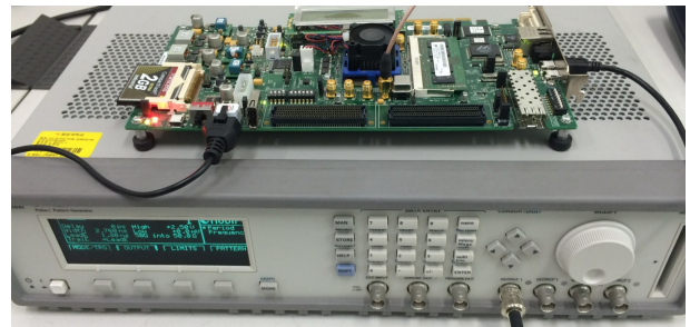
그림 9. Virtex6 보드 및 애질런트 함수발생기 사진 Fig. 9. A picture of Virtex6 board and function generator.
