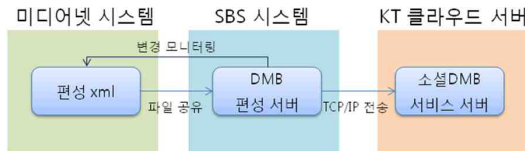
그림 8. 편성정보 시스템 구성도 Fig. 8. Block Diagram of organization program information system
