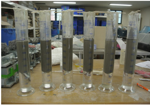
[Fig. 4] Bleeding test
