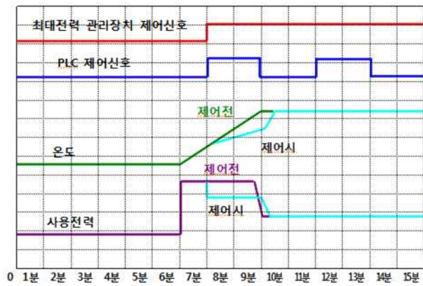
그림 6. 최대수요전력 제어에 따른 온도 및 전력의 변화 Fig. 6. Temperature & electricity change according to peak demand power control
