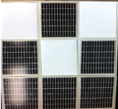
그림 23. PV 어레이의 그림자 조건 Fig. 23. Shadow condition of PV array
