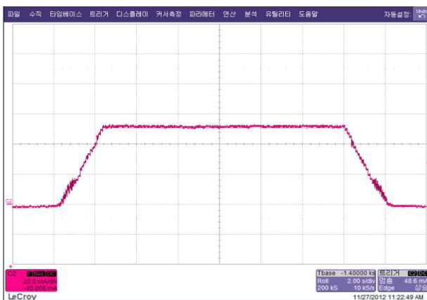
그림 5. 제작된 SOA Driver의 전류패턴 측정 Fig. 5. Measurement of current pattern from SOA Driver realized
