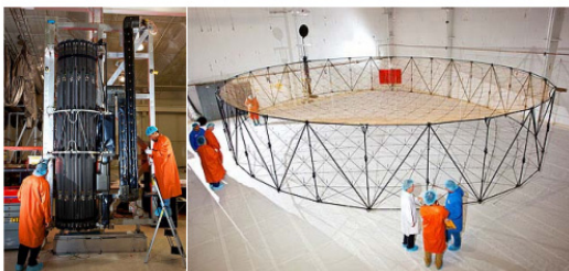
〈그림 18〉 Alphasat 우주선의 AstroMesh 전개안테나
