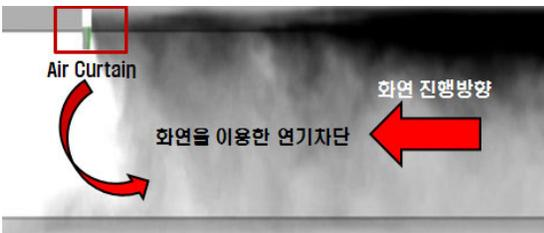
그림 1. 스마트 에어커튼 시스템 개념도
