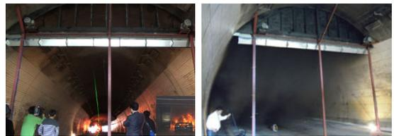
그림 12. Test Bed 도로터널 차량전소실험
