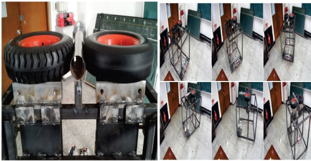
그림 10 모터 구동(좌), 제자리 우회전(우) Fig. 10 Motor operation(left), right turn motion(right)
