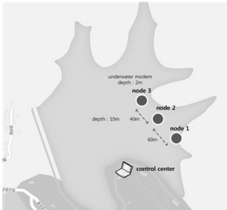
그림 2. 노드 및 지상 제어국 배치 Fig. 2. Deployment of nodes and control center
