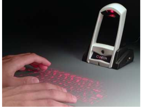
그림 4. 카네스타의 가상 레이저 프로젝션 키보드 Fig. 4. Virtual laser projection keyboard of canesta.
