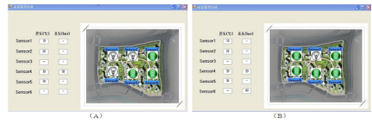
그림 3. 조도 값을 통한 인접 노드 제어규칙 실행 결과 Fig. 3. The Results of Active Rule(Adjacent Node Control using Illuminance) Execution
