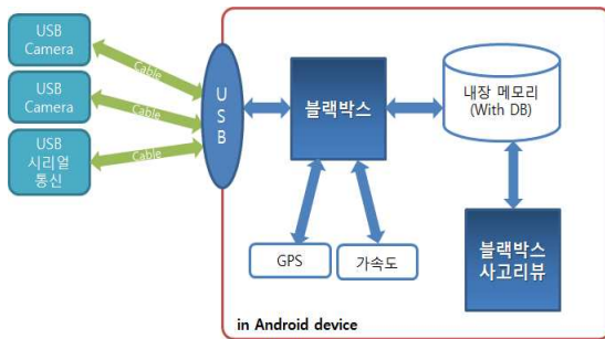
그림 3. 블랙박스 단말기 구성도 Fig. 3 Configuration of black box device
