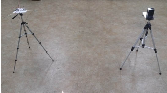
그림 4. 다채널 DB 수집 환경 (방위각 0도, 천정각 90도 예시) Fig. 4 Environment of multi-channel DB collection (Examples of azimuth 0°, elevation 90°)
