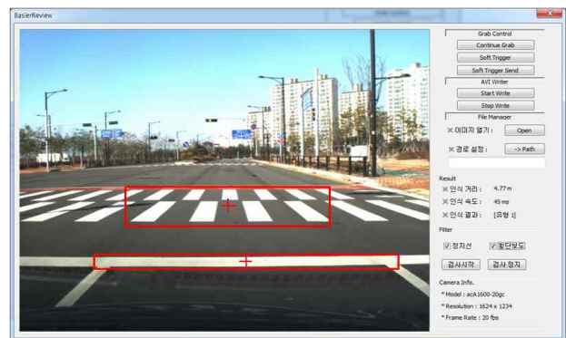
그림 8. 정지선과 횡단보도 인식 애플리케이션 UI Fig. 8. Recognition Application UI for Stop Line and Crosswalk
