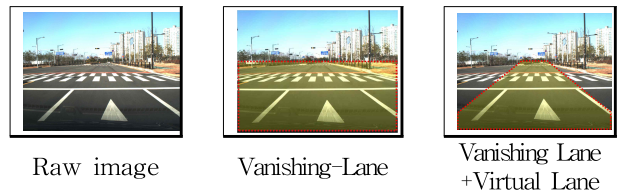
그림 3. 관심영역 설정 결과 Fig. 3. Operation Result of Inverse Perspective and Region of Interest
