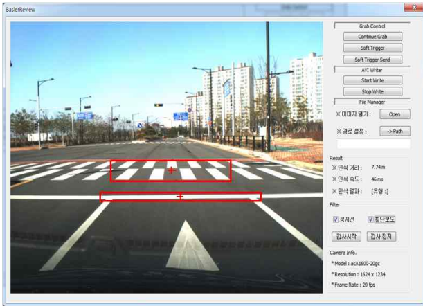
그림 9-a. 안정적 조건(유형 1, 정지선과 횡단보도 병행) Fig. 9-a. Stable Condition [Type 1.-Both]
