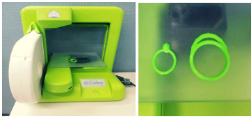
그림 6. 3차원 프린터와 제작된 반지 모형 Fig. 6. 3D printer and produced ring models
