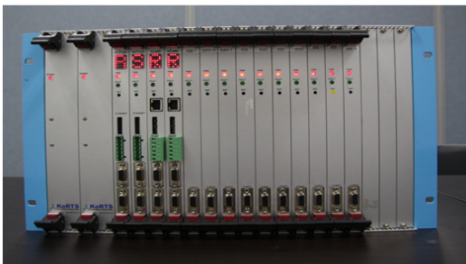
그림 3. 개발된 FPGA 기반 제어기 Fig. 3 Developed FPGA-based controller
