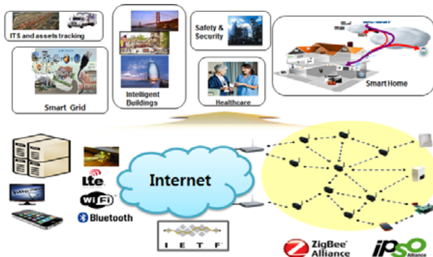
(그림 1) 사물 인터넷 서비스 및 소형 저전력 장치 연결 개념도
