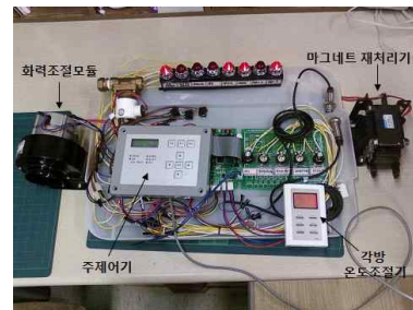
그림 17. 펠릿보일러 제어시스템 시험 셋업 Fig. 17. Experimental set-up for pellet boiler controller
