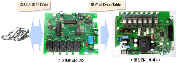
그림 15. 구현된 DTMF 제어기와 주제어기 Fig. 15. DTMF controller and main controller
