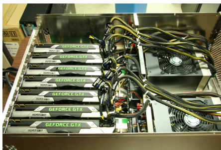
그림 14. GPU 병렬 확장을 위한 외장 데스크톱 Fig. 14 External desktop for parallel extension of GPU
