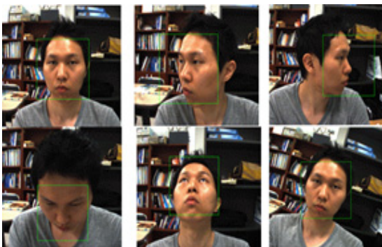
그림 3. Haar 분류기를 이용한 얼굴 영역의 검출 Fig. 3 Face region discrimination by Haar classifier
