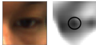
그림 6. 템플릿 매칭으로 검출된 영상 결과 Fig. 6 Template matching based pupil extraction result
