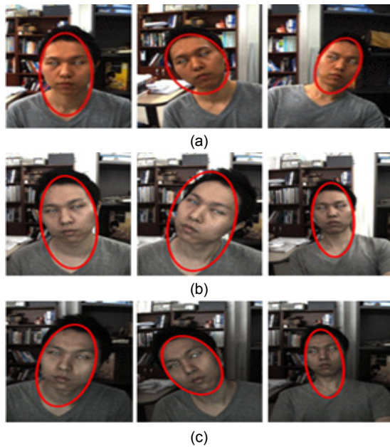
그림 9. 제안한 검출 및 추적 알고리즘의 각 조명에서의 실험 결과 (a) 가장 밝은 조명 환경 (b) 중간 밝기의 조명 환경 (c) 어두운 조명 환경
