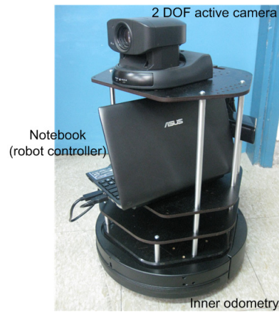
그림 5. TurtleBot 이동로봇 Fig. 5 TurtleBot mobile robot
