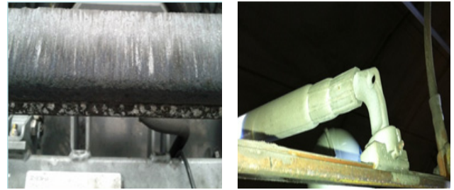
그림 5 HEMU-430X의 최고속도 운행이후 집전판과 전차선 현장점검 사진
