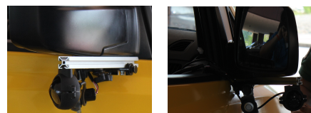
그림 2 통학버스의 사이드 미러에 장착된 카메라 Fig. 2 Attached camera under side mirror of hagwon-bus
